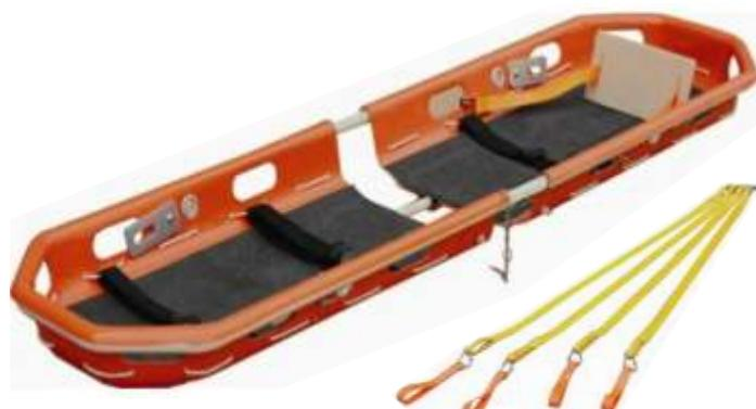
Les glissières et les poignées moulées facilitent la manipulation. Les œillets en laiton sont stratégiquement situés pour une utilisation rapide avec la sangle. Bride de levage réglable (des lignes de repère doivent toujours être utilisées lorsque vous soulevez la civière du panier). La coque résiste aux produits chimiques, aux UV, à la rouille et à la corrosion.
